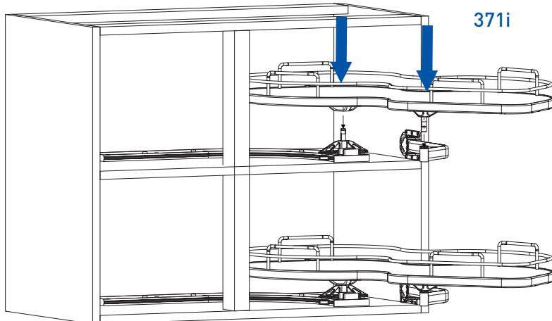
Insérer le plateau monté dans le mécanisme C et dans le support rotatif G précédemment montés.
